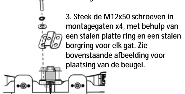
3. Steek de M12x50 schroeven in montagegaten x4, met behulp van een stalen platte ring en een stalen borring voor elk gat. Zie bovenstaande afbeelding voor plaatsing van de beugel.
