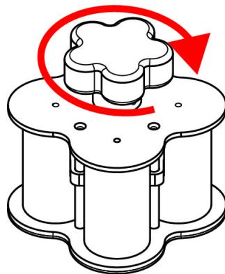
4. Suelte el MT-01 del módulo girando el mando en sentido horario.
