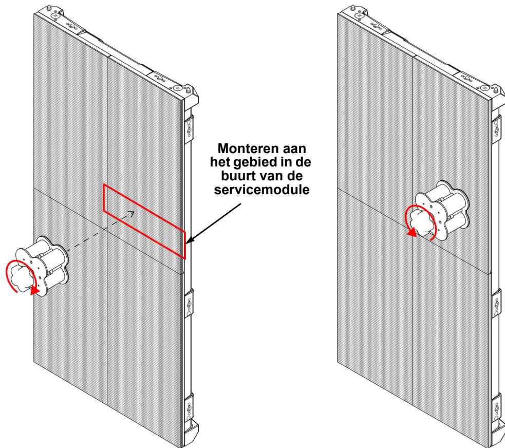
2. Plaats de MT-01 voorzichtig tegen de module, in de open stand (met de knop rechtsom gedraaid) en draai de knop tegen de klik in totdat de magneet 1 mm van de module weg is.
