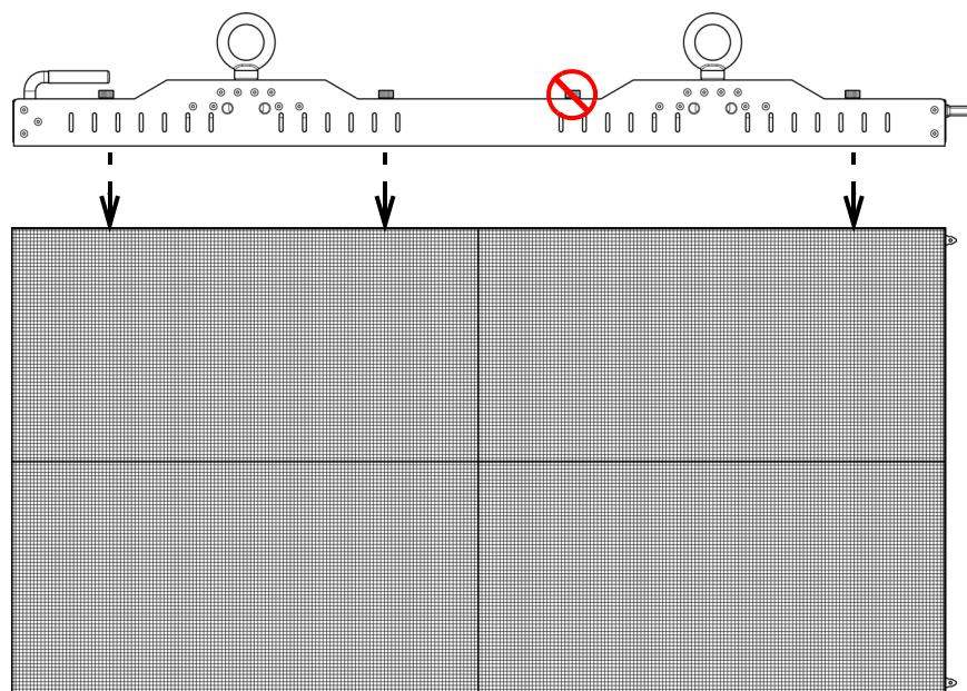
Met de RB-F100CM opbouwbalk kan de F4 IP horizontaal worden gemonteerd. Volg dezelfde instructies als bij de [Montage van de Rig Bar/het paneel](#), maar wees extra voorzichtig, aangezien de lange zijde van het product geen conische uitlijningspunten of magneten bevat.
