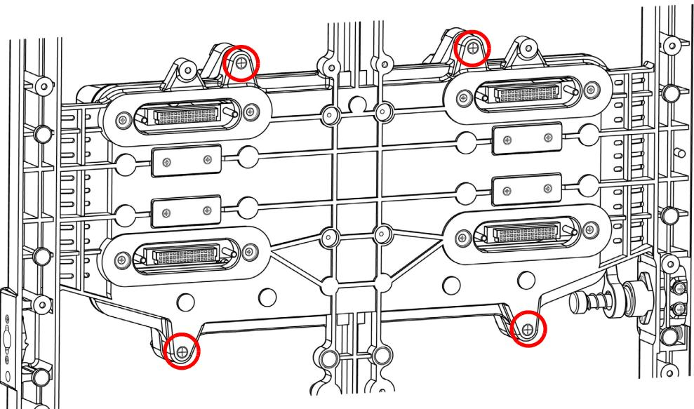
2. Enlevez les 4 vis de l'arrière du panneau en tournant les vis dans le sens des aiguilles d'une montre depuis l'avant du panneau.
