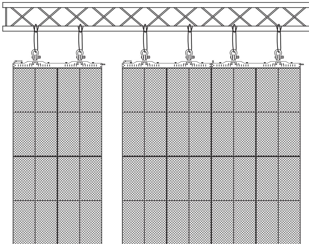
**Les points de fixation M12 et M10 ne sont pas prévus pour un accrochage ou une suspension à un treillis ou toute autre structure en hauteur.**
