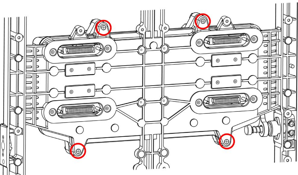
2. Verwijder de 4 schroeven van de achterzijde van het paneel door de schroeven rechtsom te draaien vanaf de voorzijde van het paneel.
