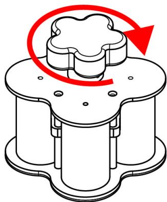
Le MT-01 est spécialement conçu pour retirer et placer avec précaution les modules LED F4 IP à l'avant lorsque le panneau est monté en configuration de mur vidéo. Avant d'utiliser cet outil, assurez-vous que l'aimant soit entièrement retiré en arrière à sa position de départ en tournant la poignée dans le sens des aiguilles d'une montre. Dans le cas contraire, si l'aimant n'est pas dans sa position de départ, vous risquez d'endommager le module.
