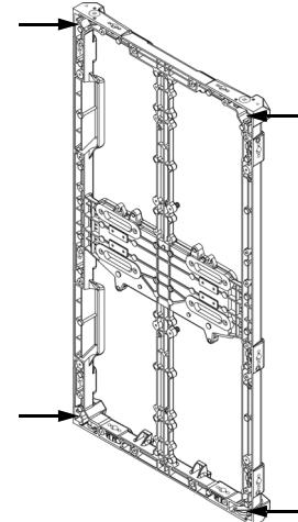
**Er moeten M12-bouten worden gebruikt voor montagetoepassingen op de achterzijde**
