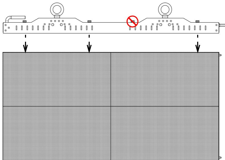
El F4 IP se puede montar horizontalmente con la RB-F100CM Rig Bar. Siga las mismas instrucciones que para la [Rig Bar/Ensamblaje del panel](#), pero con más cuidado, ya que el lado largo del producto no tiene conos de alineamiento ni imanes.
