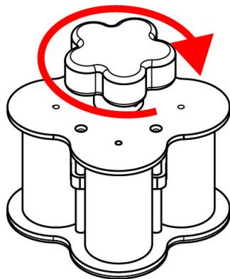
4. Détachez le MT-01 du module en tournant la poignée dans le sens des aiguilles d'une montre.
