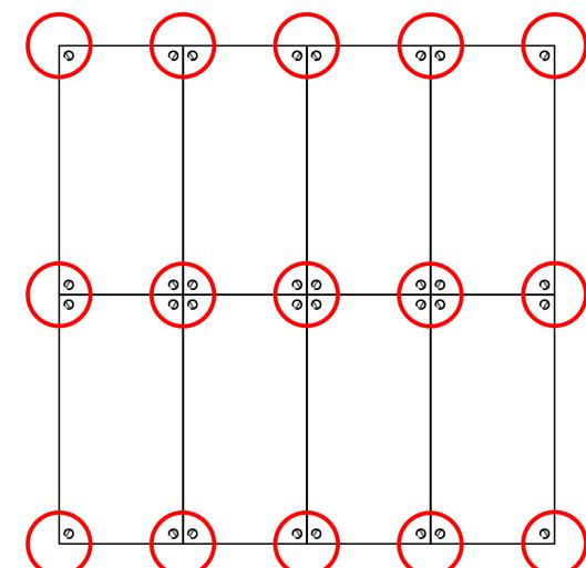
**Se debe asegurar al menos 1 punto de montaje por cada unión (marcada con un círculo), incluyendo los bordes y esquinas exteriores**
