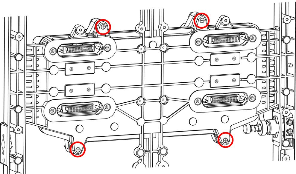
2. Quite los 4 tornillos de la parte posterior del panel girando los tornillos en sentido horario desde la parte anterior del panel.
