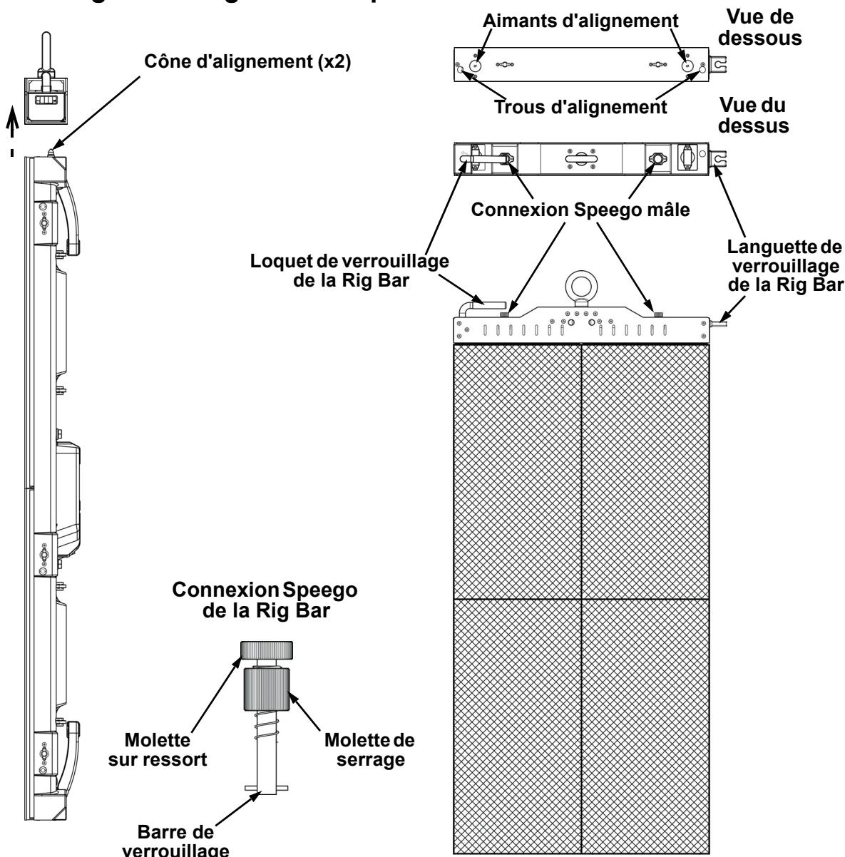
1. Insérez les cônes d'alignement dans les trous d'alignement jusqu'à ce que les aimants se connectent.
