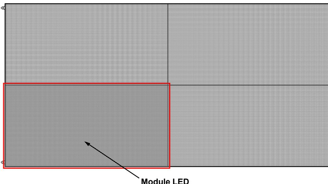
Chaque pixel est représenté par une LED tricolore. Le tableau suivant indique le nombre de pixels par panneau pour chaque modèle de F4 IP. Pour des spécifications détaillées, veuillez vous référer au tableau des [Spécifications techniques](#) à la fin de ce manuel d'utilisation.
