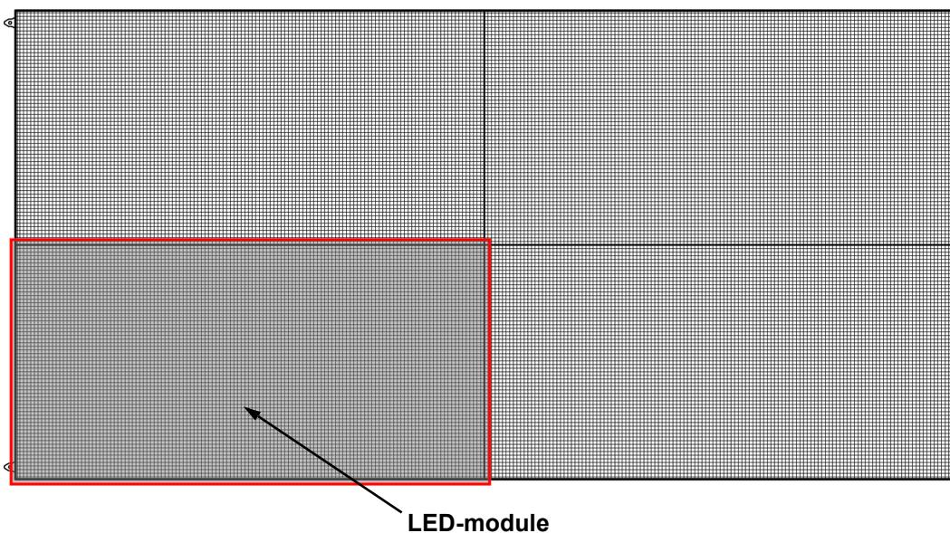
Elke pixel is 1 driekleurige LED. De volgende tabel geeft het aantal pixels per paneel in elke F4 IP. Raadpleeg voor uitgebreide specificaties de [Technische specificaties](#) tabel aan het einde van deze gebruikershandleiding.
