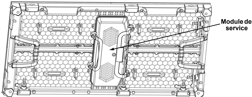
L'accès au module de service F4 IP ainsi que sa maintenance peuvent être effectués aussi bien depuis l'arrière que l'avant du panneau à n'importe quel moment, ce qui évite au technicien de se déplacer de l'autre côté d'un panneau vidéo entier plusieurs fois pour effectuer la maintenance d'un seul panneau. Suivez les instructions ci-dessous pour accéder au module de service F4 IP depuis l'avant du panneau:
