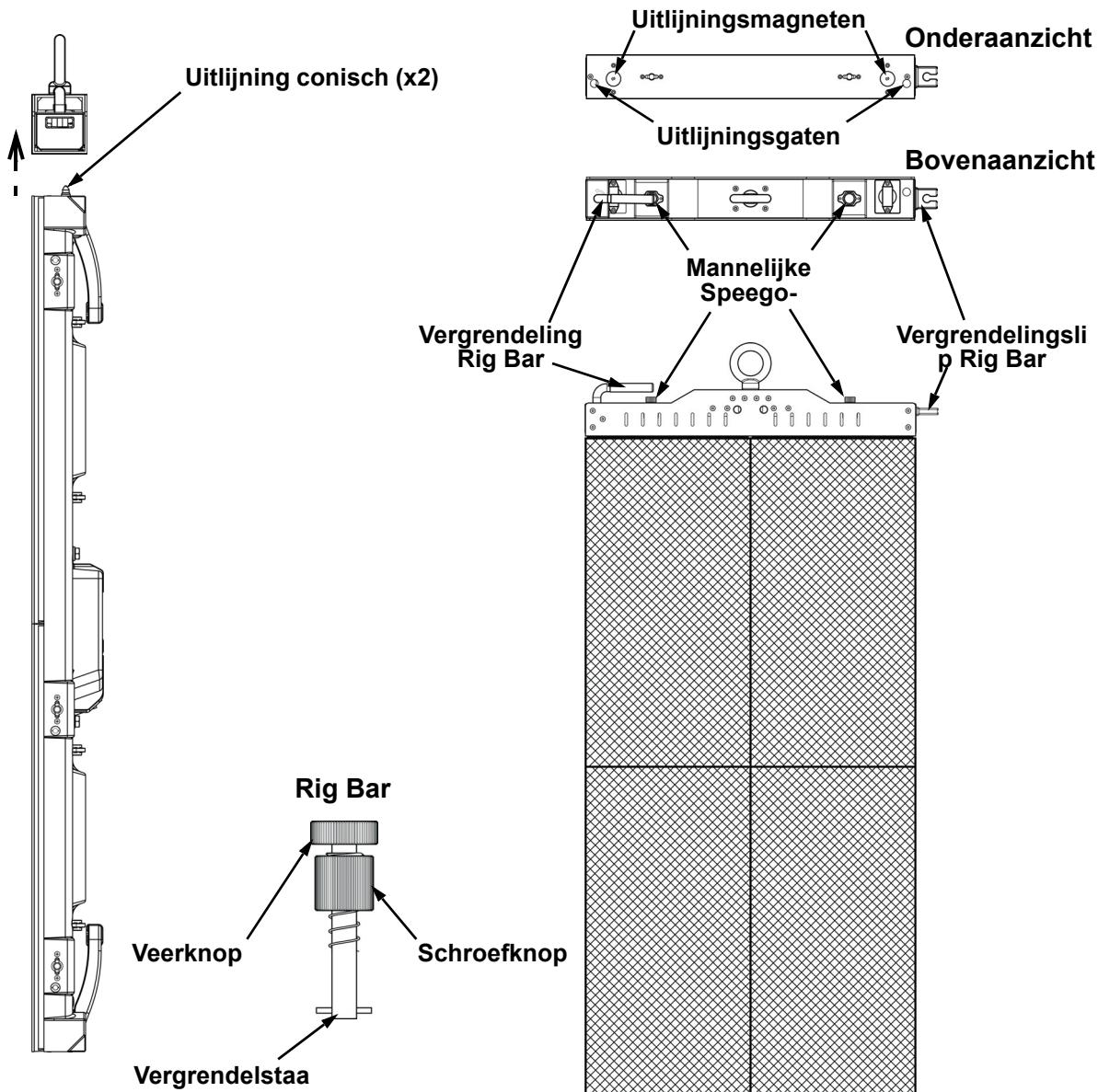
1. Steek de conische uitlijningspunten in een uitlijningsgaten en laat de magneten koppelen.
