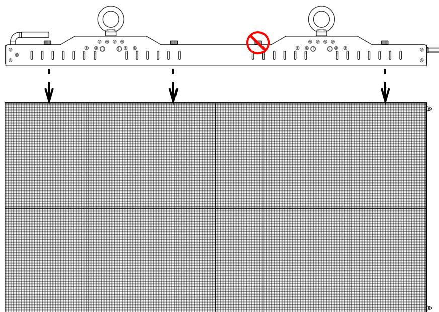
Le F4 IP peut être installé à l'horizontale avec la barre d'attache RB-F100CM. Suivez les mêmes instructions que pour [Assemblage de la Rig Bar et du panneau](#), tout en prenant un soin particulier car les côtés longs de l'appareil ne disposent pas de cônes d'alignement ou d'aimants.
