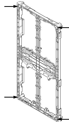
**Se deben utilizar pernos M12 para las aplicaciones de montaje posterior**
