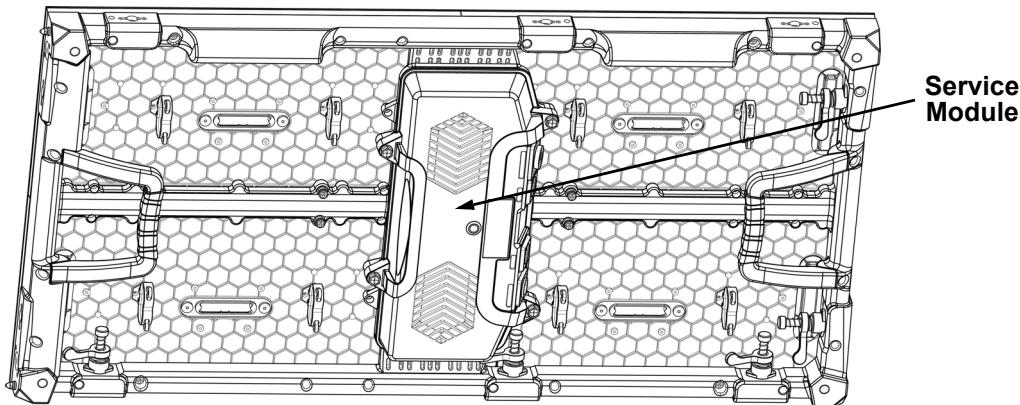
De F4 IP-servicemodule kan op elk moment worden geopend en onderhouden aan de voorzijde van het paneel of aan de achterzijde van het paneel. Een monteur hoeft dus niet meerdere malen rond een hele videowand te lopen voor het onderhoud aan één paneel. Volg de onderstaande instructies voor toegang tot de F4 IP-servicemodule vanaf de voorzijde van het paneel:
