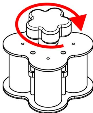
De MT-01 is speciaal ontworpen om de F4 IP-LED-module voorzichtig voorzichtig te verwijderen en te vervangen van de voorzijde wanneer het paneel in een videowand is gemonteerd. Voordat u dit gereedschap gebruikt moet u controleren of de magneet volledig is teruggetrokken naar de startpositie, door de knop met de klok mee te roteren. Als de magneet niet in de startpositie wordt geplaatst kan de module beschadigd raken.
